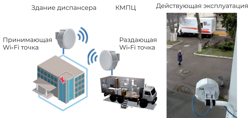
Рисунок 5 — Схема автоматической пересылки изображений в PACS через защищенный Wi-Fi-мост.
